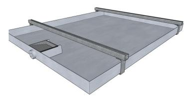
**Schritt 4** – Schieben Sie die Nutsteine mit bereits eingedrehter Schraube in die Schienen und positionieren Sie diese so nah wie möglich an den Stellen, wo die Schrauben in die Anlage eingedreht werden.
