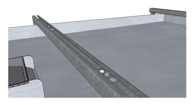
**Schritt 5** – Positionieren Sie nun die Anlage auf den Montageschienen und drehen die Schrauben fest, sodass das ganze System fest miteinander verbunden ist.
